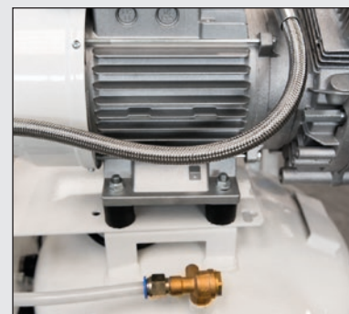
Gumové podstavce pre zníženie prenosu vibrácií z kompresoru
